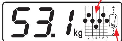
Bij iedere weegbeurt wordt uw gewicht automatisch geregistreerd en wordt de grafiek weergegeven. De grafiek kan max. 7 achtereenvolgende weegbeurten weergeven.
