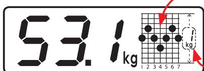
A ogni pesata, il vostro peso viene memorizzato automaticamente e visualizzato nel grafico. Il grafico può visualizzare fino a 7 pesate successive.
