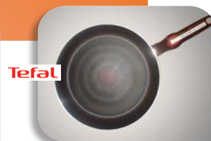
Poêle TEFAL après 16 000 cycles d'abrasion
