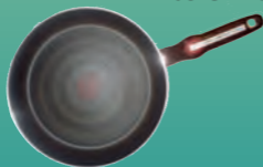
Poêle TEFAL après 16 000 cycles d'abrasion soit 4,5 années d'utilisation intensive*
